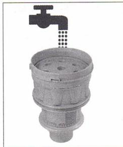
6. Bei Bedarf spülen Sie den Kunststoff-Staubfilter mit klarem, lauwarmem Wasser gründlich aus. **Achtung: Reinigen Sie den Filter auf keinen Fall in der Wasch- oder Spülmaschine!** Schütteln Sie überschüssiges Wasser anschließend ab und lassen Sie ihn vollständig an der Luft trocknen.
