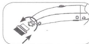
2. Stecken Sie eine Bürste auf den Dampfaufsatz und Bürstenadapter und drehen Sie die Bürste, bis sie fest sitzt.
