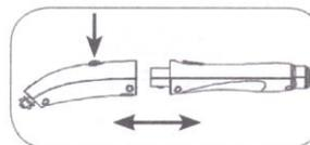
1. Stecken Sie den Dampfaufsatz und Bürstenadapter (1) auf den Griff (21).
